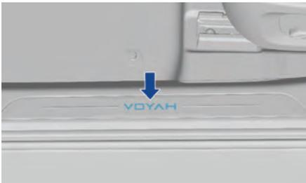
Лампы подсветки находятся под декоративными накладками порогов дверей, обеспечивая освещение для водителя и пассажиров при посадке и высадке.
