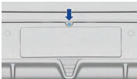
Камера заднего вида расположена между двумя фонарями подсветки номерного знака на заднем бампере и используется для получения информации о пространстве, расположенном за автомобилем.
