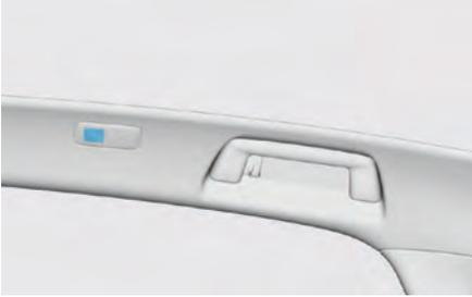
– Нажмите на потолочный плафон – он загорается. При повторном нажатии плафон гаснет.
