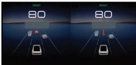
При срабатывании системы AEB выполняется экстренное торможение, и подаются предупреждения: на комбинации приборов динамически отображаются различные предупреждающие сообщения об опасности столкновения с пешеходом или транспортным средством, сопровождаемые звуковым предупреждением. Выводится текстовое предупреждение: «Идет экстренное торможение!» до тех пор, пока действуют предупреждения.
