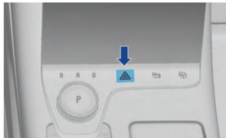
Выключатель аварийной световой сигнализации расположен в центре вспомогательной панели управления.
