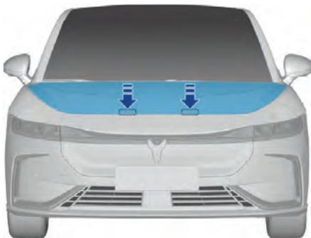
1. Нажимайте на капот до тех пор, пока защелки замков капота не коснутся фиксаторов.
