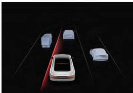
Система помощи при выходе из полосы движения включает в себя две основные функции помощи водителю: предупреждение о выходе из полосы движения (LDW) и помощь в удержании автомобиля в пределах полосы движения (LKA). С этой целью в системе используются интеллектуальные датчики движения для определения продольных линий разметки полосы движения и расчета параметров фактического положения вашего автомобиля в полосе движения (траектории автомобиля).
