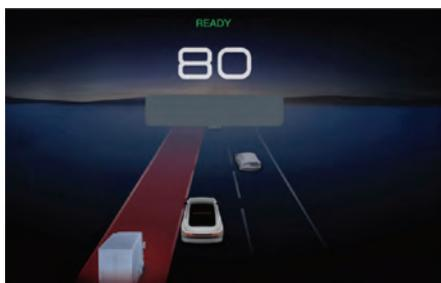
Система ELK с помощью интеллектуальных датчиков следит за движением в соседних полосах движения. Когда распознается тенденция к выезду вашего автомобиля из занимаемой полосы и возникает риск столкновения с автомобилем на соседней полосе или выезд за границу дороги, система ELK активно направляет автомобиль в сторону занимаемой полосы движения, что позволяет избежать столкновения или снизить риск аварии.
