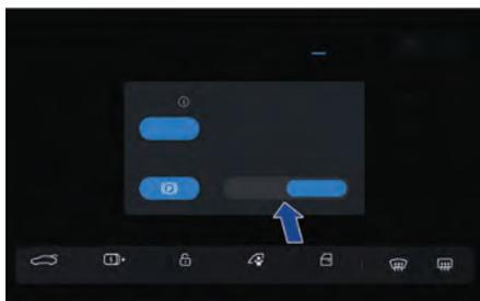
Вы можете настроить функцию Auto Hold следующим образом: автоматический (нормальный) режим / режим включения при сильном нажатии педали тормоза в меню управления автомобилем, подменю шасси на центральном дисплее. Автоматический режим – режим, используемый по умолчанию.
