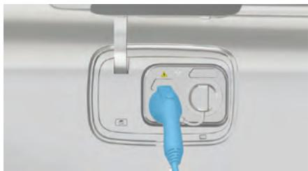
4. Загорается световой индикатор зарядки на комбинации приборов, и отображается состояние зарядки. Одновременно с этим загораются индикаторы зарядного разъема и пистолета портативного зарядного устройства.
