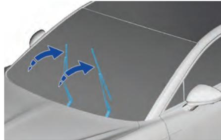
4. Выключите режим обслуживания очистителя ветрового стекла, и рычаги автоматически возвращаются в исходное положение.
