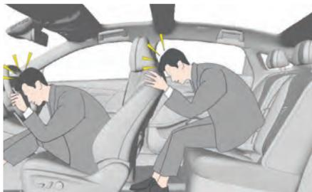
При столкновении автомобиля водители и пассажиры, не пристегнутые ремнями безопасности, могут по инерции вылететь из автомобиля и получить тяжелые травмы. Даже если скорость движения автомобиля очень мала, сила, действующая на тело человека при столкновении, очень велика. Кроме того, велика вероятность вторичных столкновений.
