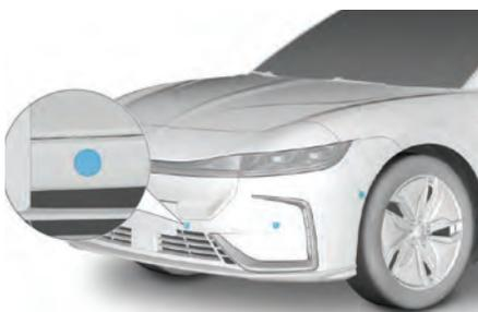
Передние парковочные датчики устанавливаются в передний бампер автомобиля (всего 6 шт.).
