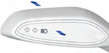
Когда включен ближний свет фар, переместите рычаг комбинированного переключателя приборов освещения в направлении передней панели, чтобы включить дальний свет. При этом загорается индикатор дальнего света
