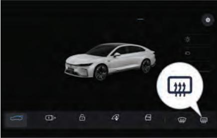
На центральном дисплее управления коснитесь кнопки обогрева заднего стекла. При этом включается функция обогрева для удаления следов влаги или льда с заднего стекла и наружных зеркал заднего вида. При повторном касании выключателя функция выключается.
