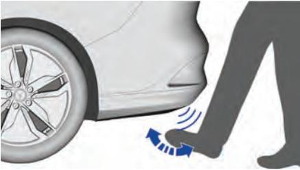
При нахождении смарт-ключа в зоне идентификации автомобилем подведите стопу ноги под центр заднего бампера (не менее чем на 10 см вглубь), чтобы открыть / закрыть крышку багажника с электроприводом. Во время закрывания крышки багажника снова быстро подведите стопу ноги под бампер, чтобы приостановить перемещение крышки багажника.
