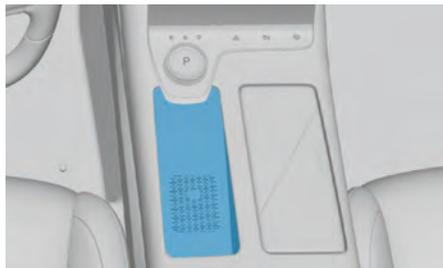
Лоток индукционной беспроводной зарядки мобильных телефонов расположен на центральной консоли. Функцию беспроводной зарядки можно включить / выключить на центральном дисплее в меню общих настроек подключений. Мощность беспроводной зарядки составляет 50 Вт.
