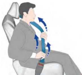
Ремни безопасности сидений переднего и второго рядов оснащены преднатяжителями с ограничителями натяжения, что позволяет значительно повысить защиту водителя и пассажиров при фронтальном, боковом или попутном столкновении. В зависимости от силы столкновения после срабатывания преднатяжителя ремень безопасности практически мгновенно натягивается, а ограничитель натяжения ослабляет давление ремня безопасности на грудную клетку, благодаря чему повышается эффективность защиты человека от травм.
