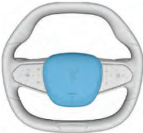
В любом месте крышки посередине рулевого колеса нажмите для включения звукового сигнала. При отпускании звуковой сигнал выключается.
