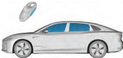
Выйдите из автомобиля и закройте все двери, нажмите и удерживайте кнопку запираения/отпираения дверей на смарт-ключе для автоматического подъема/опускания стекол боковых дверей.
