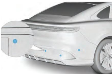
Задние парковочные датчики устанавливаются в задний бампер автомобиля (всего 6 шт.).
