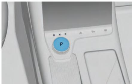
Автомобиль оснащен электронной системой переключения передач с поворотной ручкой селектора. Можно использовать четыре передачи: «Р», «R», «N» и «D». После включения питания (режим «READY») нажмите педаль тормоза, чтобы включить передачу. После успешного включения передачи загорается соответствующий индикатор передачи на панели переключения передач; кроме того, выбранная передача отображается на дисплее комбинации приборов.
