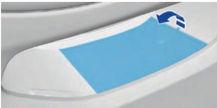
2. Снимите крышку ароматизатора в задней части вспомогательной управления панели (см. рис. ниже) и извлеките блок контейнеров с ароматами.
