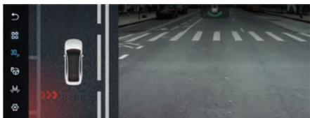
Когда эта система обнаруживает опасность столкновения, на соответствующем боковом наружном зеркале заднего вида загорается световой сигнализатор, и подается звуковое предупреждение; если при этом включена система кругового обзора, на дисплее также отображается предупреждение.
