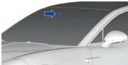
Датчик, с автоматическим управлением наружным освещением, расположен в центре верхней части ветрового стекла. Не закрывайте эту часть какими-либо устройствами / предметами и держите ее в чистоте, чтобы не влиять на автоматический режим управления наружным освещением.
