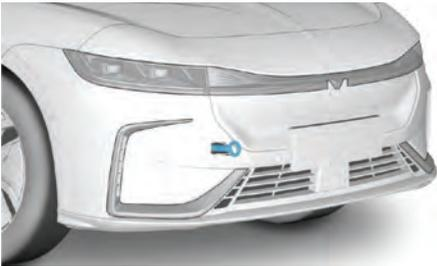
4. Прикрепите буксировочный трос. Рекомендуется отдать предпочтение жесткой сцепке, а буксировочный трос следует использовать только при отсутствии соответствующей сцепки.
