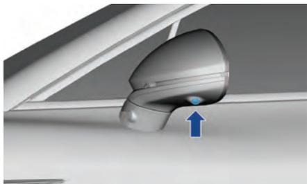
Левая и правая камеры расположены в нижней части корпусов наружных зеркал заднего вида и используются для получения информации о пространстве, расположенном по бокам от автомобиля.
