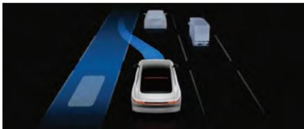
Система (TLC) обнаруживает пространство для перестроения на соседних полосах с помощью датчиков интеллектуальных систем помощи водителю, определяет, соответствуют ли текущие дорожные условия требованиям для перестроения, и помогает водителю выполнить перестроение на соседнюю полосу движения.
