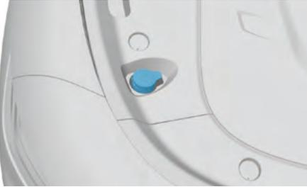
Омыватель ветрового стекла расположен в передней части салона. Регулярно проверяйте и своевременно доливайте жидкость омывателя ветрового стекла.
