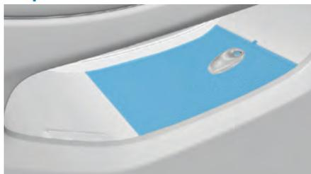
При низком уровне заряда элемента питания смарт-ключа включить зажигание / электропитание автомобиля можно, поместив смарт-ключ в зону аварийного запуска (см. рисунок выше) и нажав педаль тормоза после того, как все двери и багажник закрыты.
