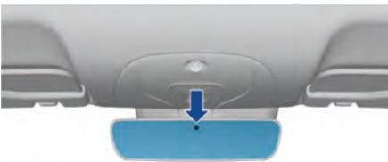
При движении в темное время суток при попадании на внутреннее зеркало заднего вида лучей яркого света автоматически регулируется отражающая способность зеркала, чтобы отраженный свет не ослеплял водителя.
