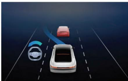
Система ESA с помощью интеллектуальных датчиков движения распознает окружающую обстановку с определением положения, скорости движения и других параметров, находящихся поблизости объектов. Когда во время движения возникает риск столкновения вашего автомобиля с объектом, находящимся перед вашим автомобилем, система осуществляет экстренное подруливание, чтобы избежать столкновения или смягчить его.
