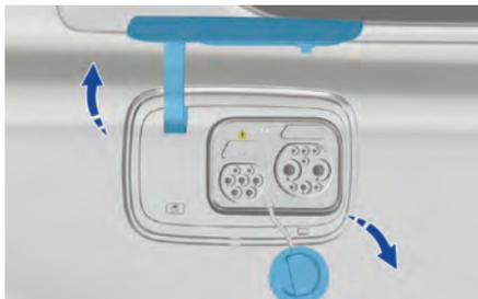
2. Подсоедините пистолет, поставляемый с зарядным устройством, к разъему автомобиля для зарядки постоянным током.
