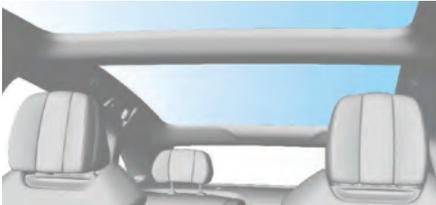
Панорамная крыша позволяет сделать салон автомобиля светлым и прозрачным, улучшает обзорность и видимость, а также выполняет функции теплоизоляции и защиты от ультрафиолетовых лучей.
