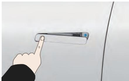
2. Одновременно с этим вытяните ручку так, чтобы она полностью выдвинулась, открывая замочный цилиндр.
