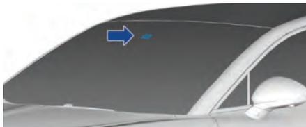
Если после запираения дверей датчик/освещенности дождя автомобиля обнаруживает дождь и окна дверей закрыты не полностью, окна автоматически закрываются.
