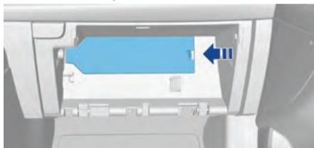
3. Нажмите на фиксатор с правой стороны крышки салонного фильтра и снимите крышку фильтра.
